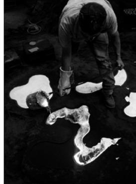
Da sich nicht beliebig große Objekte in einem Guss herstellen lassen, werden größere Möbel von einzelnen Modellteilen abgeformt. Die Abgüsse werden anschließend verschweißt.
