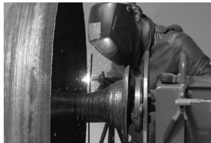
herstellen. Mit dem in der Schweißpistole geschmolzenem Schweißdraht, Libertiny verwendet Edelstahlschweißdraht 316, wird Schweißpunkt für Schweißpunkt die gewünschte Form aufgebaut.
