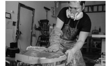
wird über den Stein herausragender Kunststoff abgetrennt und das komplette Rohr wird solange geschliffen bis durch die Bearbeitung entstandene Spuren entfernt sind. Abschließend wird das komplette Möbelstück poliert.
