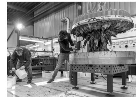
Behälter bestimmt die Form des darin erhärtenden Materials. Ein Imagevideo der „Goudsmit Magnetics Group“ zeigt die Produktion eines Tisches. Ein im Durchmesser 1,30m messender Elektromagnet hängt von der Decke der auf Magneten spezialisierten Firma. Die Magnetfläche wird durch ein darunter angebrachtes Blech geschützt.
