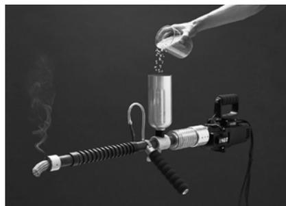
Das zweite Modell wurde zumindest äußerlich professionalisiert, funktioniert aber nach dem alten Prinzip. Anhand des ersten Gewehrs lässt sich gut erkennen, wie es konstruiert ist und wie der Kunststoff geschmolzen und extrudiert wird.
