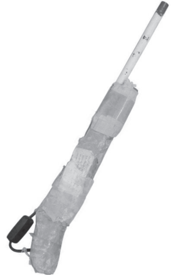
Schussapparat Stahlrohr/Streichholz- köpfe/Wolframdraht/ Kippschalter/Blockbat- terie/Papier/Klebeband JVA Celle Geiselnahme 1984
